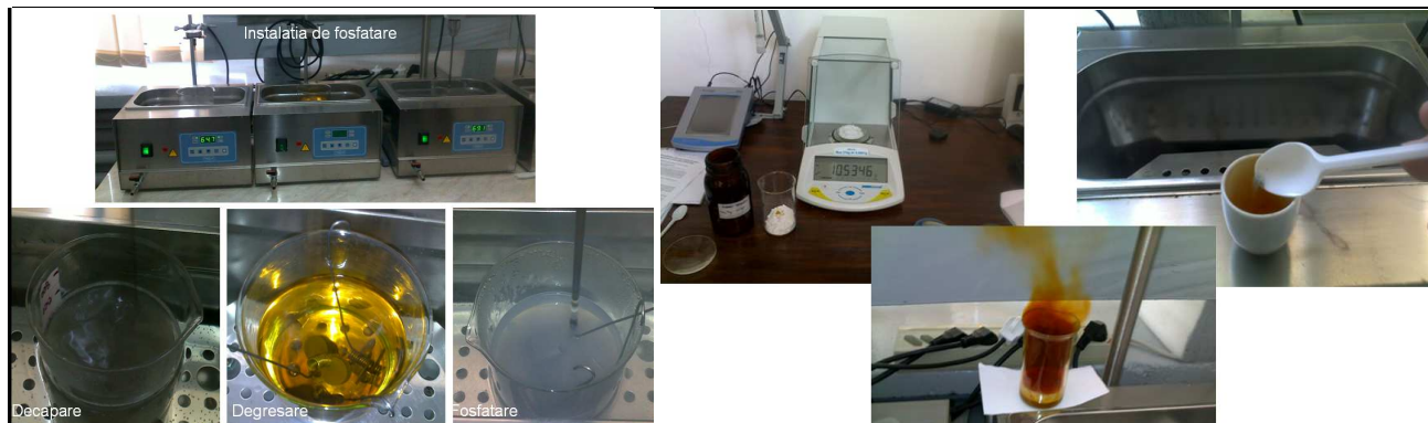
Instalația de fosfatere și Prepararea soluțiilor
