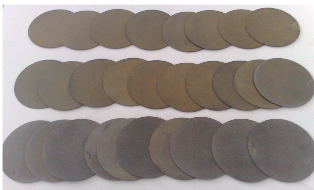
Probe metalice dupa fosfatari (table din otel cu diametrul de 40 mm)
